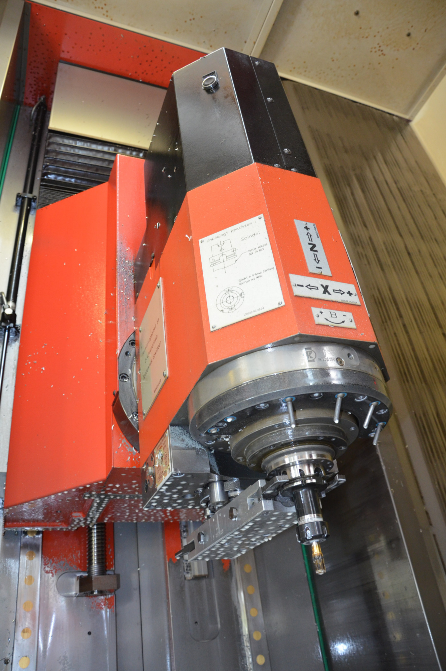
Das Kraftwerk! Der Universalkopf der Matec 30 HV trägt eine 30 kW Motorspindel mit 42 000 U/min und maximal 191 Nm Drehmoment. Bild: mav
