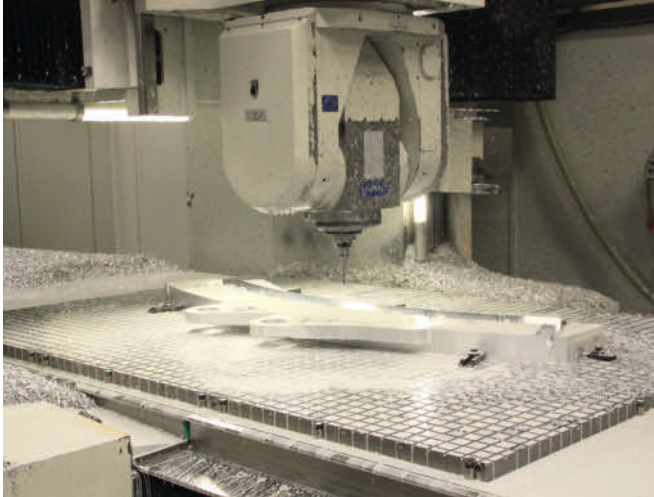
2 Jede Menge Späne: Die Portalfräsmaschine mtec-30 P entwickelt mit ihrem 2-Achs-Gabelkopf eine sehr hohe Zerspanleistung. Die Späne werden mit einer Späne-Brikkettieranlage zu handlichen Brikketts gepresst und füllen dennoch einen Lkw pro Tag
