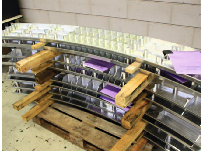
3 Von 750 kg Rohmaterial bleiben 50 kg Fertigteil übrig: Bei der hochpräzisen Bearbeitung von Elementen für den Triebwerksrahmen der Ariane 5 arbeitet die Portalfräsmaschine mtec-30 P prozesssicher in sehr anspruchsvollen Genauigkeitsbereichen
