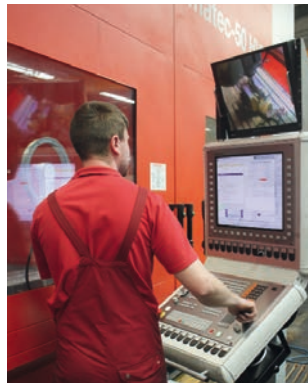
Die 50 HVU ist mit einer Heidenhain iTNC ausgerüstet und bietet über eine Kamera Bilder aus dem Bearbeitungsraum.
