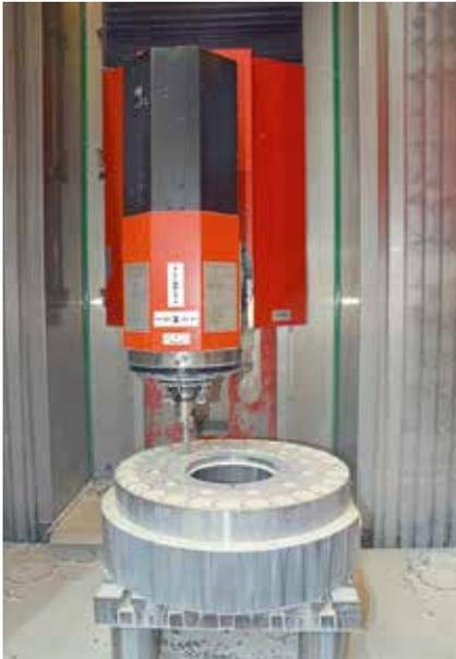
**5 Hochpräzise Bohrungen:** Bei den Böden für die eigengefertigten Hydraulikzylinder müssen sämtliche Anschlüsse und auch die Ebenheit hundertprozentig passen – je nach Komponente auch in verschiedensten 3D-Winkellagen [© Hanser]
