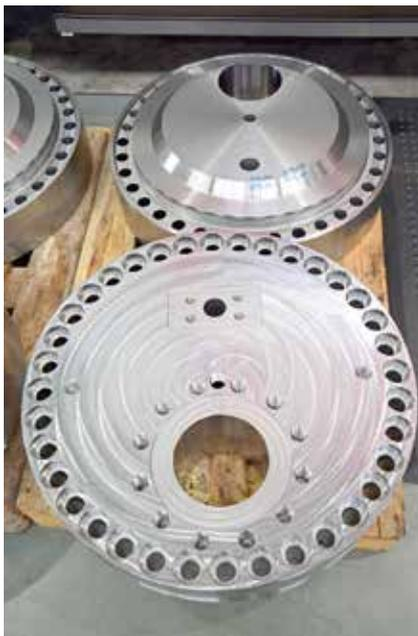
**4** Böden von selbst gefertigten Hydraulikzylindern: Langzauner kann sich bei der spanenden Bearbeitung auf die Präzision der 5-Achs- und 6-Achs-Fahrständer-BAZ von Matec verlassen (© Hanser)
