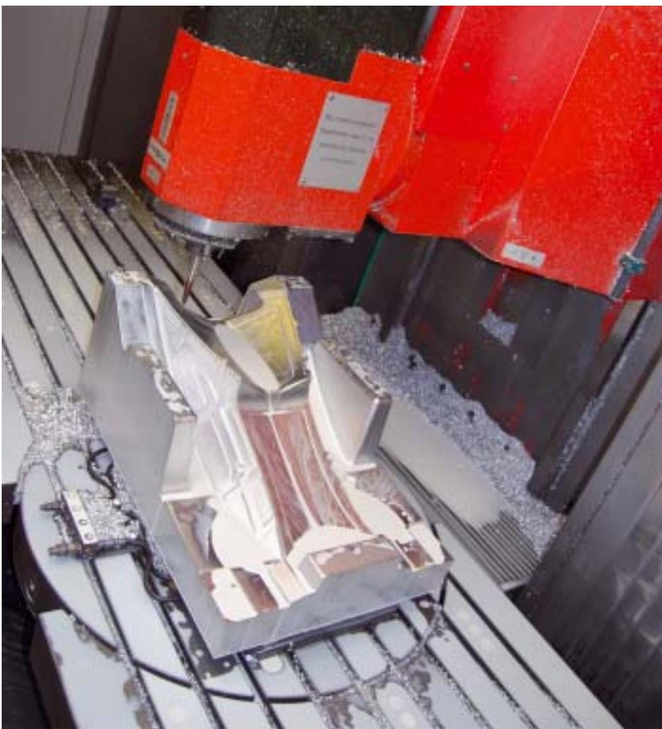
Schwenkkopf und Drehtisch ermöglichen die 5-Achs-Bearbeitung
