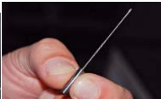
Wenn es um Kavitäten geht, die später Verstärkungsrippen abformen, kommen Fräser bis 0,8 mm Durchmesser zum Einsatz, und das bei großen Auskraglängen
