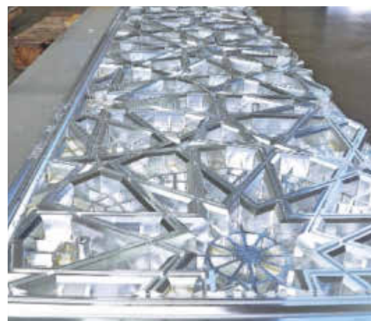
Bei Amato werden filigranste Ornamente aus dem Vollmaterial gefräst.
