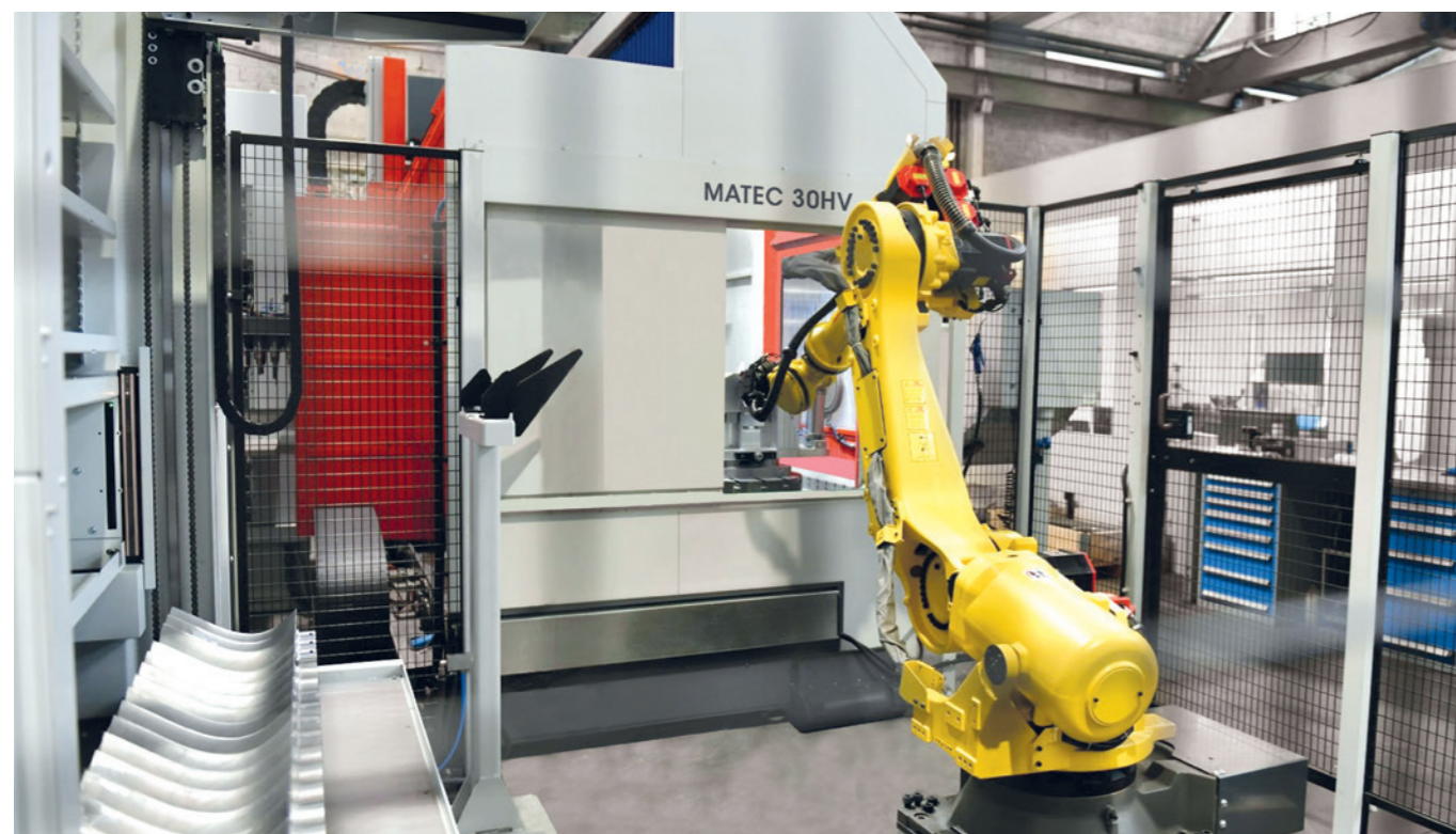
5 Achs-Serienfertigung von Turbinenschaufeln.
