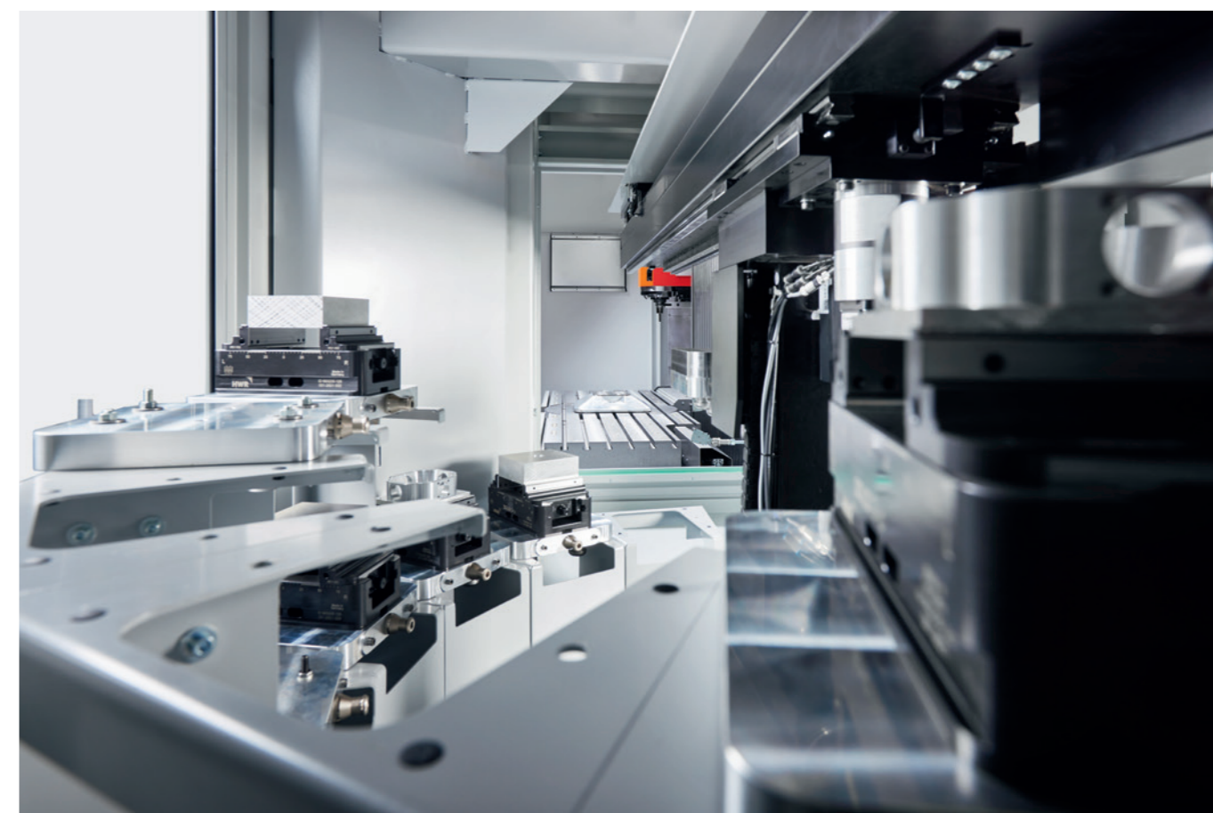
Paletten-Rundspeicher mit Palettenhandling.
