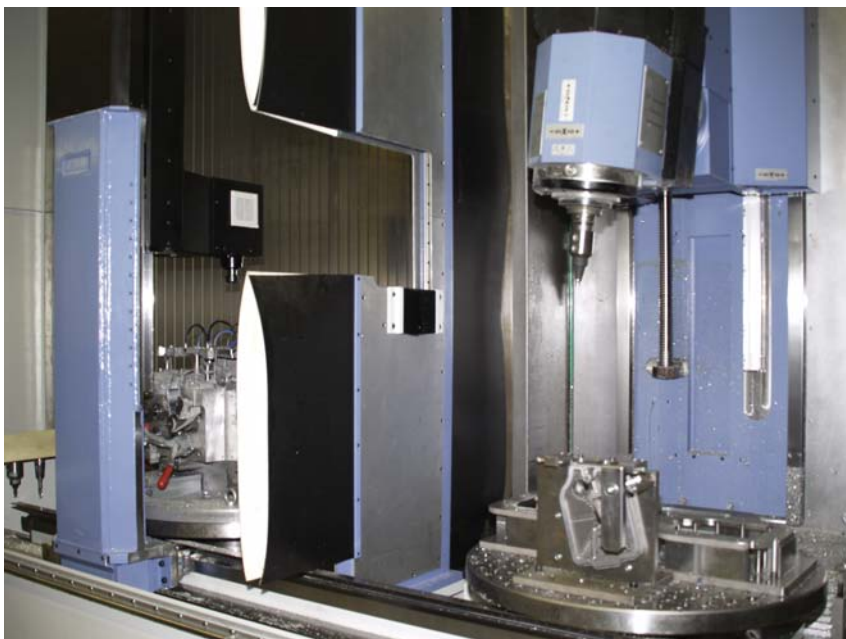
6 Auf nebenzeitarmen Pendelbetrieb getrimmte matec-30 HV: vor dem linken Arbeitsraum mit fertig geschweißten Bauteilen ist der vordere Fahrständer mit Entgratspindel zu sehen; im rechten Arbeitsraum kann die Hauptspindel zeitgleich rührreißschweißen
