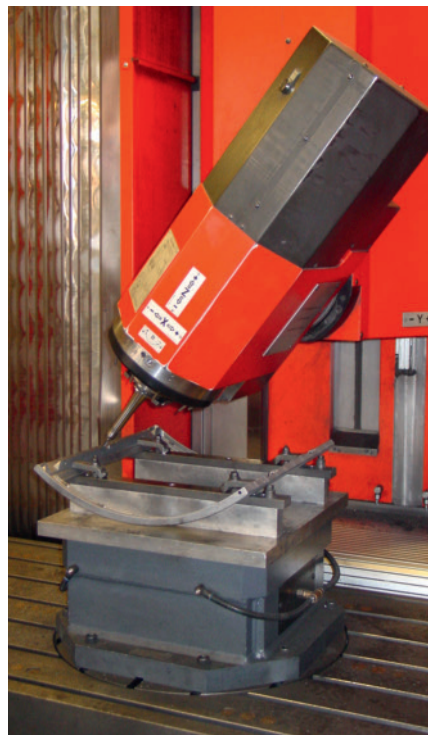
7 Horizontal, vertikal und dazwischen: Der Schwenkkopf der Matec-BAZ sorgt in Kombination mit dem eingelassenen Torque-Rundtisch für eine dynamische Werkzeugpositionierung, selbst bei großen Bauteilen
