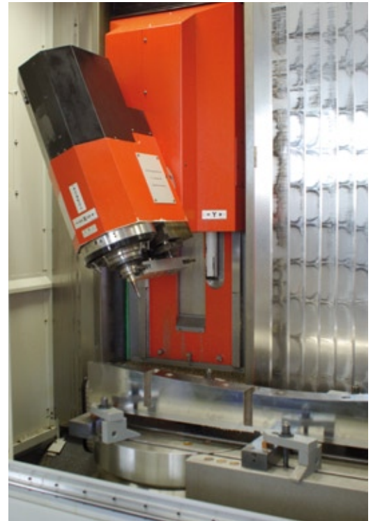
Die Motorspindel mit 18.000 min -1 im matec-NC-Schwenkkopf eignet sich für das kraftvolle Schrapp- und Schlichtbearbeitungen von Freiformflächen.
