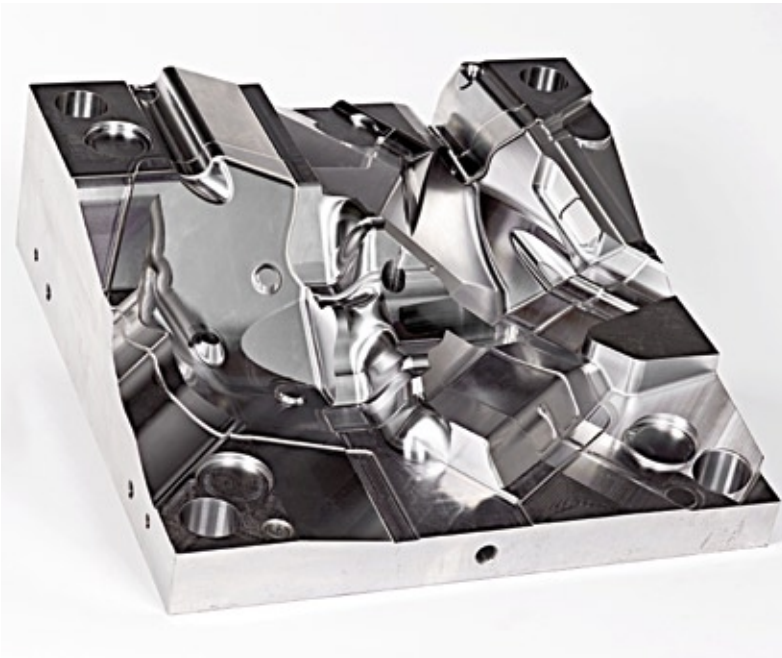
Der Polieraufwand des auf der matec-30HVK finish-gefrästen 52 HRC harten Formteils hat sich bei der Firma Sigel nach dem Finish-Fräsen von drei Tagen auf einen Tag reduziert.
