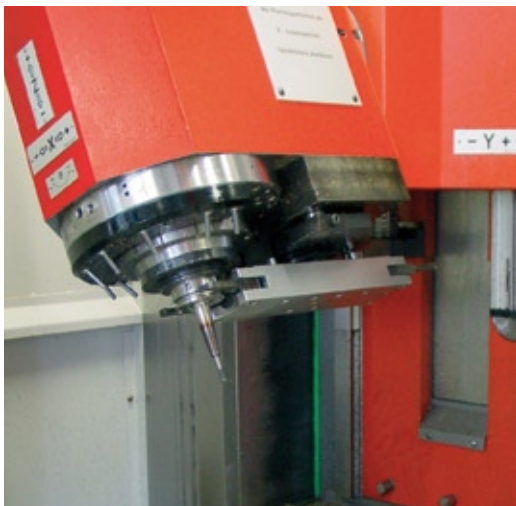
Durch den Doppelgreifer und durch das mitfahrende Werkzeugmagazin lässt sich ein Werkzeugwechsel in jeder XY-Position schnell durchführen.
