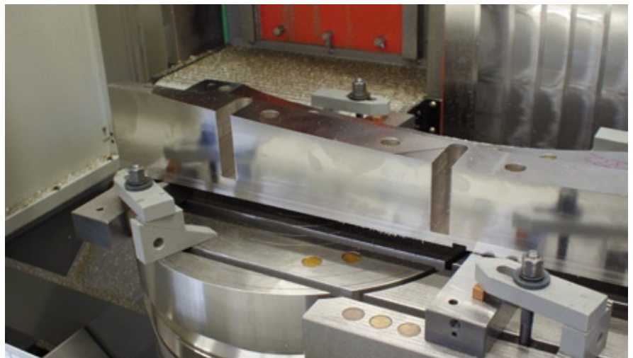
Der in den starren Maschinentisch integrierte NC-Rundtisch mit Ø 630 ermöglicht Werkstückdimensionen bis zu einem Schwingkreisdurchmesser von 940 mm und verlängert durch seinen bündigen Einbau die Tischaufspanfläche für lange Werkstücke.
