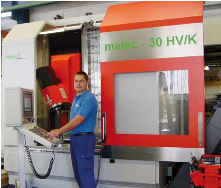
Fahrständerbearbeitungszentrum matec-30 HVK, das aus dem umfangreichen matec-Baukasten aus Standardbaugruppen optimal auf die Anforderungen im Werkzeug- und Formenbau zugeschnitten ist.
