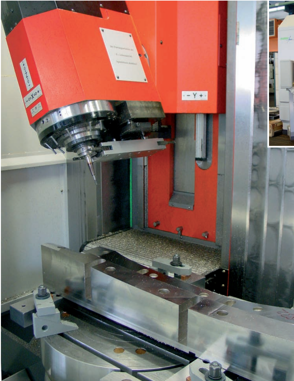
Fahrständerbearbeitungszentrum matedc-30 HVK, das aus dem umfangreichen matedc-Baukasten aus Standardbaugruppen optimal auf die Anforderungen im Werkzeug- und Formenbau zugeschnitten ist.
