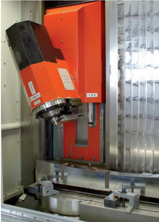
Die Motorspindel mit 18000 U/min im matec-NC-Schwenkkopf eignet sich mit dem im Fahrständer integriertem Torque-Direktantrieb und einem Schwenkwinkelbereich von +- 105 ° für das kraftvolle Schrupp- und Schlichtbearbeitungen von Freiformflächen.
