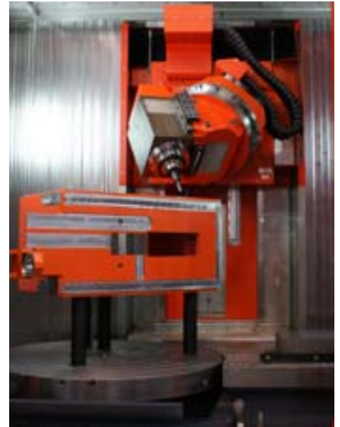
Bei entsprechender Werkstück-Aufspannung ermöglicht der Universal-Winkelkopf auch die 6-Seitenbearbeitung
