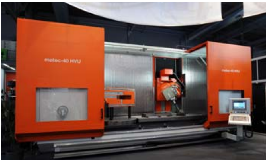
Fahrständerbearbeitungszentrum Matec 40 HVU mit Universalkopf
