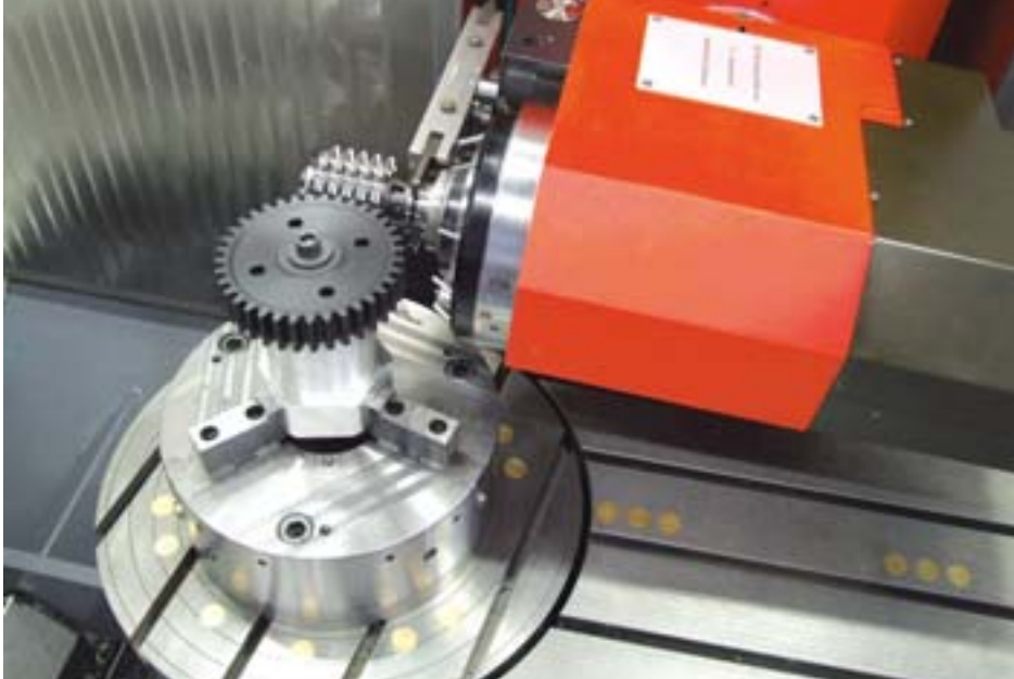
Zahnradfräsen auf der Universalmaschine
