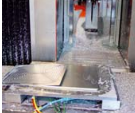
Blechteile werden verzugsfrei mit Vakuumspannplatten gespannt
