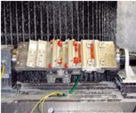
Schwenkbare Mehrfachspanneinrichtung für Design-Leisten aus Aluminium
