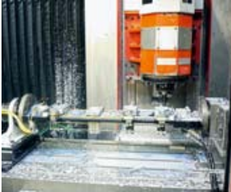
Schwenkspannbrücke für besonders empfindliche Hohlkammerprofile aus Aluminium
