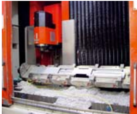
Schwenkspanneinrichtung für besonders lange Hohlkammerprofile aus Aluminium
