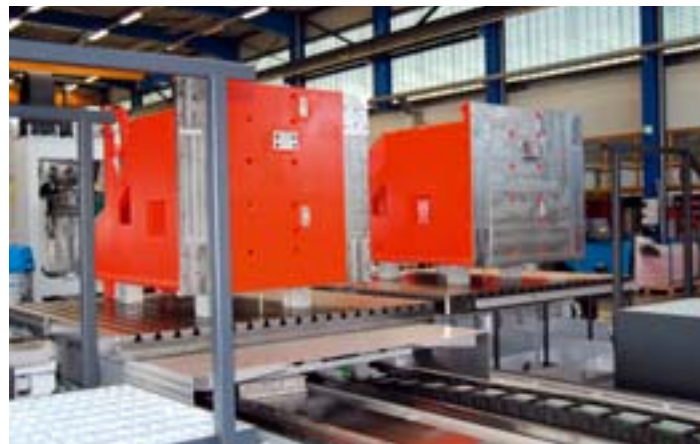
Der Palettenwechsler erlaubt hauptzeitparalleles Rüsten (links)
