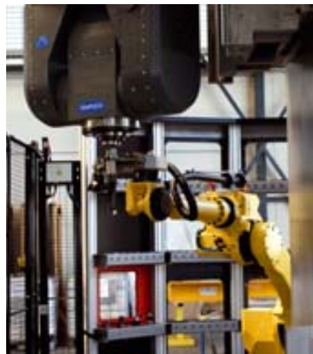
Der Gabelkopf ist mit einer kraftvollen Spindel bestückt, die satte 30 kW leistet und eine HSK 63-Schnittstelle bietet. Bei der Zerspansung ermöglicht sie die 5-Seitenbearbeitung
