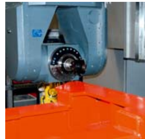
Der Gabelkopf ist mit einer kraftvollen Spindel bestückt, die satte 30 kW leistet und eine HSK 63-Schnittstelle bietet. Bei der Zerspansung ermöglicht sie die 5-Seitenbearbeitung
