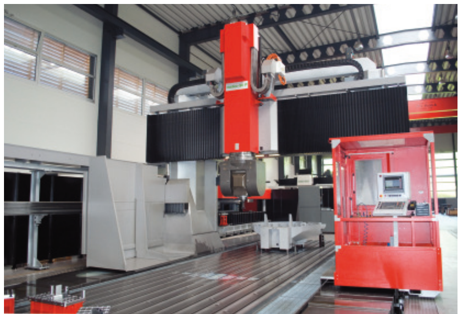
Ein Trend im Maschinenbau ist die Großteilebearbeitung: Im Bild ist eine Portalmaschine „matedc-50 P“ mit 16 m Verfahrweg zu sehen, die beim Schweizer CNC-Dienstleistungsunternehmen Procam ihren Dienst verrichtet.
