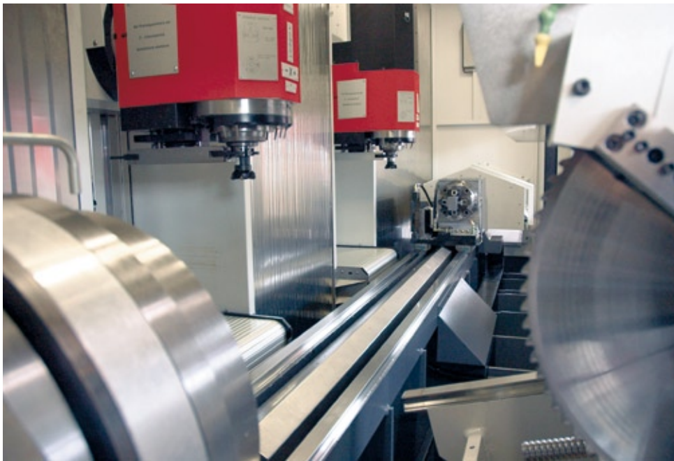
Verfahrwege des Fahrständers in X bis 12.000 mm lassen sich wahlweise mit konventionellem Kugelgewinde- oder verschleißfreiem schnelleren Linearantrieb realisieren.
