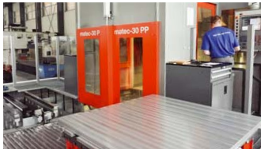
Das Portalzentrum matec-30 PP von Pro-Cam hat einen X-Verfahrweg von 6 m. Es ist die erste Maschine aus Köggen mit beweglichem Tisch und Palettenwechsler. Sie schruppt und schlichtet bis zu 21 Stunden täglich Aluminium, Stahl oder Guss Bilder: Industrieanzeiger
