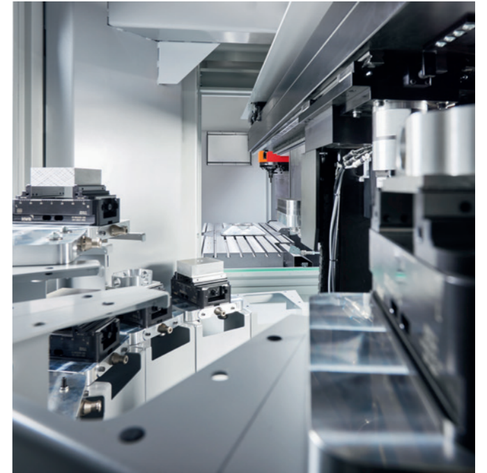
Paletten-Rundspeicher mit Palettenhandling.
