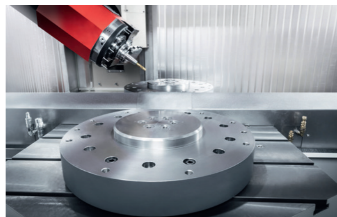
Abbildung der beiden Arbeitsräume mit geöffneter Sicherheitstrennwand.
