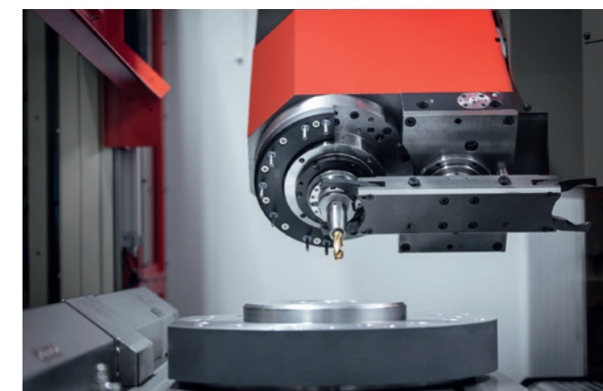
Stufenloser Schwenkkopf für Mehrseiten- oder Endenbearbeitung.
