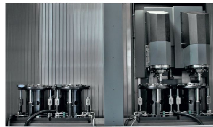
Pendelbearbeitung mit zwei Arbeitsräumen. Ausführung ohne Festtisch, jedoch mit Konsolen für den Vorrichtungs-aufbau bei hohen Werkstücken.
